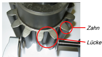
Abb. 207: Ein Beispiel für die Zahnradscheibe mit dem Verhältnis Zahn:Lücke = 3:2.
